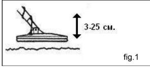
Quando il potenziometro è ruotato molto a sinistra, si sente un tono basso quando la bobina di ricerca si avvicina alla superficie del terreno, mentre in posizione molto a destra, quando la bobina si allontana dal terreno, si sente un tono alto. Ruotare il potenziometro finché il tono non cambia o cambia solo leggermente.
