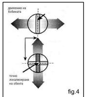
La posizione precisa del metallo rilevato viene determinata spostando la bobina di ricerca lungo due assi perpendicolari (Fig. 4).
