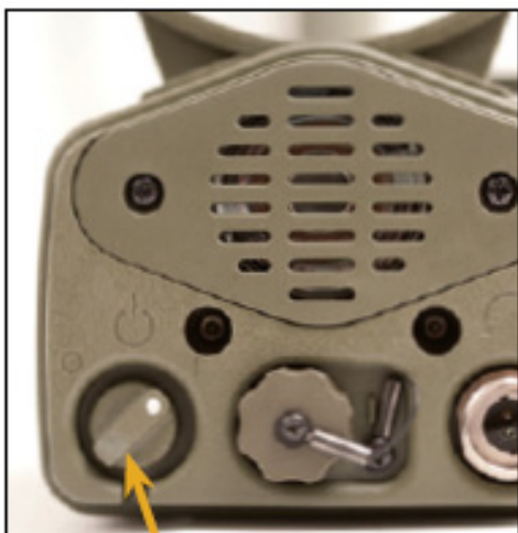
Switch accensione e spegnimento (mostrato in posizione On acceso)
