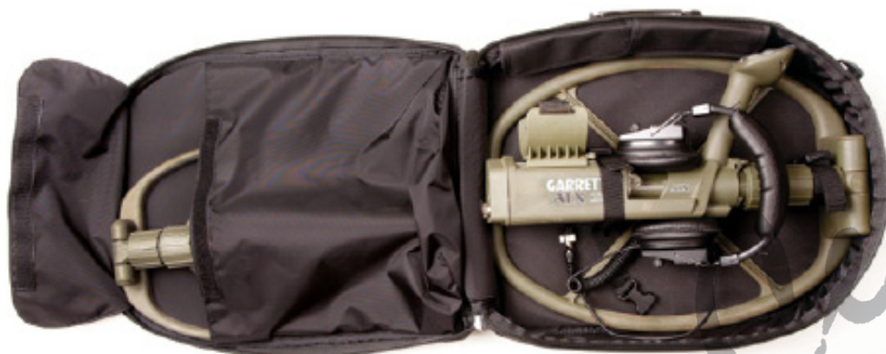
Figura 5: ATX con piastra Deepseeker installata + cuffie + piastra DD. Nota: la tasca con chiusura con velcro tiene ferma la piastra DD.
