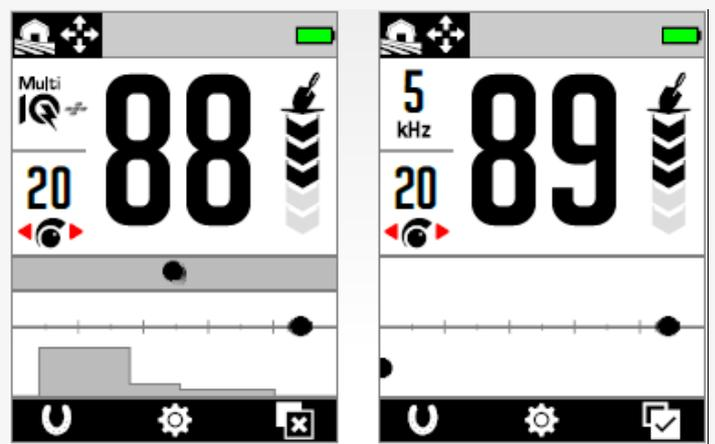
Questo esempio mostra la rilevazione di una moneta e di un chiodo in Multi-IQ+, e poi di nuovo utilizzando un'unica frequenza. Mentre la traccia e l'ID della moneta rimangono molto simili, il chiodo di ferro appare in basso a sinistra quando si lavora a singola frequenza.
