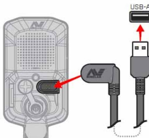
3. Il LED verde dello stato di carica in alto a sinistra dell'unità di controllo lampeggerà lentamente. Quando la batteria è completamente carica, il LED di stato della carica rimarrà acceso.
