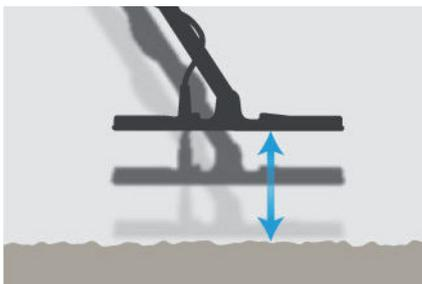
Ascoltare la risposta audio per interpretare il risultato della procedura di bilanciamento; un tono basso indica che è necessario aumentare il valore del bilanciamento del terreno e un tono alto indica che è necessario diminuirlo.
