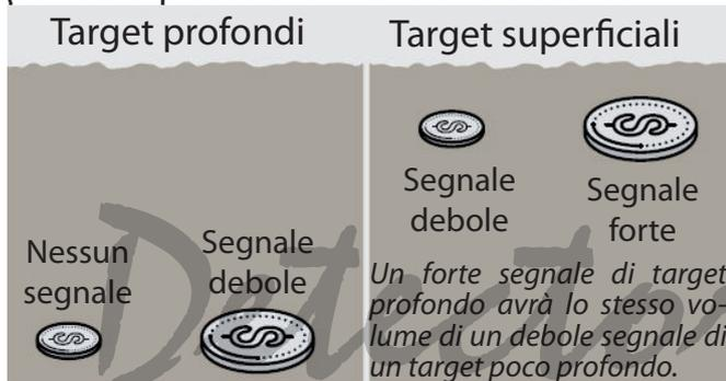
Il suono prodotto dal metal detector in modalità Pinpoint o Bilanciamento del Terreno (Ground Balance) varia in volume e tono a seconda della potenza del segnale (in base alla mineralizzazione del bersaglio o del terreno). Questo intervallo di volume è proporzionale all'impostazione del volume massimo.
