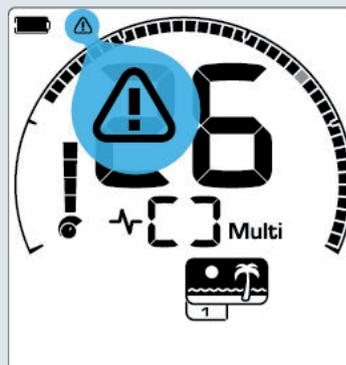
*L'indicatore di sovraccarico appare quando viene ridotta automaticamente la potenza del segnale di trasmissione.*
