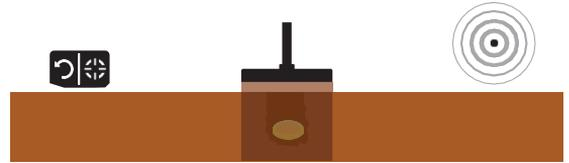
5) Ripeta la procedura precedente cambiando la direzione di 90°. Le azioni da eseguire da un paio di direzioni diverse restringeranno l'area del bersaglio e le forniranno i dettagli più precisi della posizione del bersaglio.
