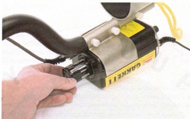
Figura 8, Corretta reinstallazione del pacco batterie
