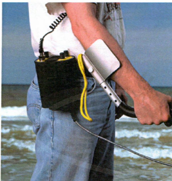
Figura 5, configurazione con control box a cintura
