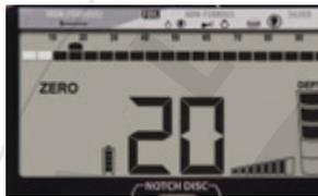
In questa illustrazione, Apex sta funzionando in modalità Zero Disc con due pixel di ferro eliminati. Questo chiodo viene segnato tra 18 a 24 sulla scala Target ID digitale. Per eliminare il chiodo dal rilevamento, disattivare altri tre pixel di ferro.
