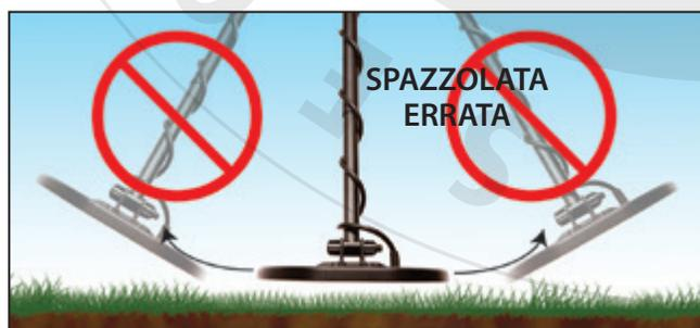
Spazzolate con la piastra parallela alle linee di aratura del terreno e al bordo dell'acqua. Questo ridurrà al minimo gli effetti negativi causati da terreni irregolari in campi arati e quantità variabili di umidità vicino all'acqua. Non spazzolate in direzione perpendicolare alle linee di aratura e al bordo dell'acqua, in quanto ciò può produrre bruschi cambiamenti nella risposta al suolo che possono ridurre le prestazioni del metal detector.
