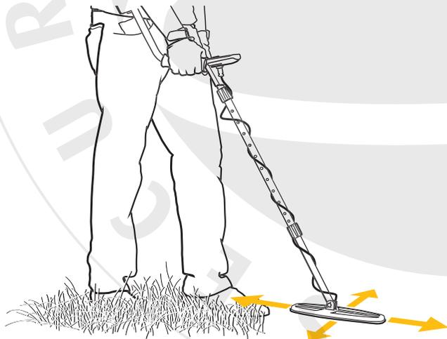
Per ottenere risultati ottimali, mantenete un'altezza costante al di sopra del terreno (ad esempio 2,5 cm).
