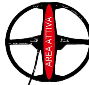
L'assemblaggio del rivelatore è un'operazione molto semplice. Fissare la bobina alla sezione inferiore dell'asta, usando il bullone e la vite di plastica forniti e già montati sulla bobina. Collegare il cavo della bobina al box di controllo. Usando le cinghie in velcro in dotazione, stringere bene il cavo della bobina intorno all'intera asta. Prestare particolare attenzione al cavo nei pressi della bobina: esso deve essere posizionato al di fuori dell'area attiva della bobina di ricerca.
