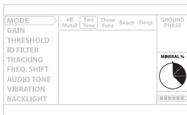
L'indicatore di mineralizzazione consiste in 8 livelli. Viene visualizzato vuoto a bassi livelli di minerali e all'avvio. Nelle aree in cui la mineralizzazione è alta, l'indicatore aumenta secondo la quantità. Questa misurazione può essere definita come proprietà magnetica e intensità del terreno. In pratica, se si cerca in un'area che contiene un'intensa mineralizzazione, il livello sarà alto. Se si lavora su un terreno povero di minerali, il livello sarà basso.
